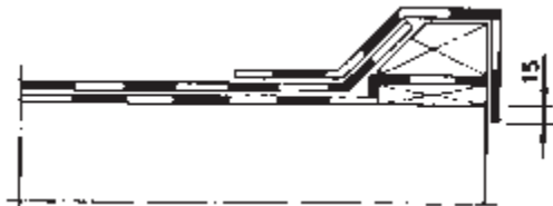
Kuva 1. Saneeraustyö, korotettu räystääs, 1-kermikate.
