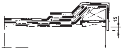
Kuva 2. Saneeraustyö, korotettu räystäs, 2-kermikate.
