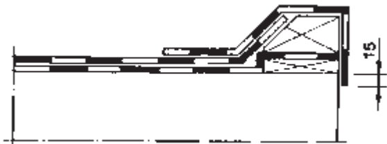
Kuva 1. Saneeraustyö, korotettu räystääs, 1-kermikate.
