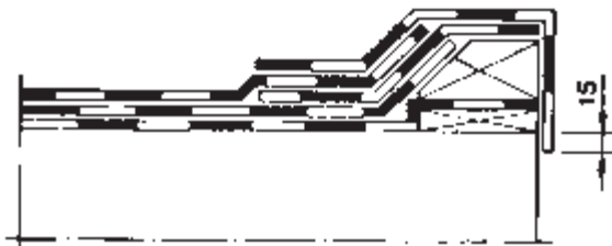
Kuva 2. Saneeraustyö, korotettu räystääs, 2-kermikate.
